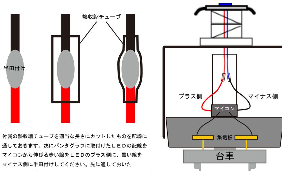
付属の熱収縮チューブを適当な長さにカットしたものを配線に通しておきます。次にパンタグラフに取付けたLEDの配線をマイコンから伸びる赤い線をLEDのプラス側に、黒い線をマイナス側に半田付けしてください。先に通しておいた熱収縮チューブを半田付けした位置に動かし半田ゴテを軽く近づけます。熱でチューブが縮んで配線側面（半田面）が絶縁・固定されます。
