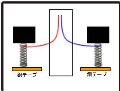
ボディーを閉めた際に銅テープに対してスプリングが多少縮む位置に接着、固定します。
